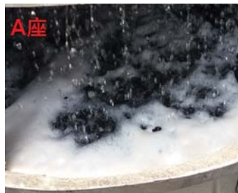
A 座：一週水質即已污濁，UT303 被污染物遮蔽。
