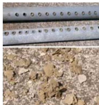
➡ UT303 投放 4 天灑水杆被脫落的水垢堵塞
