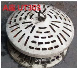
A 座：一週水質即已污濁，UT303 被污染物遮蔽。
